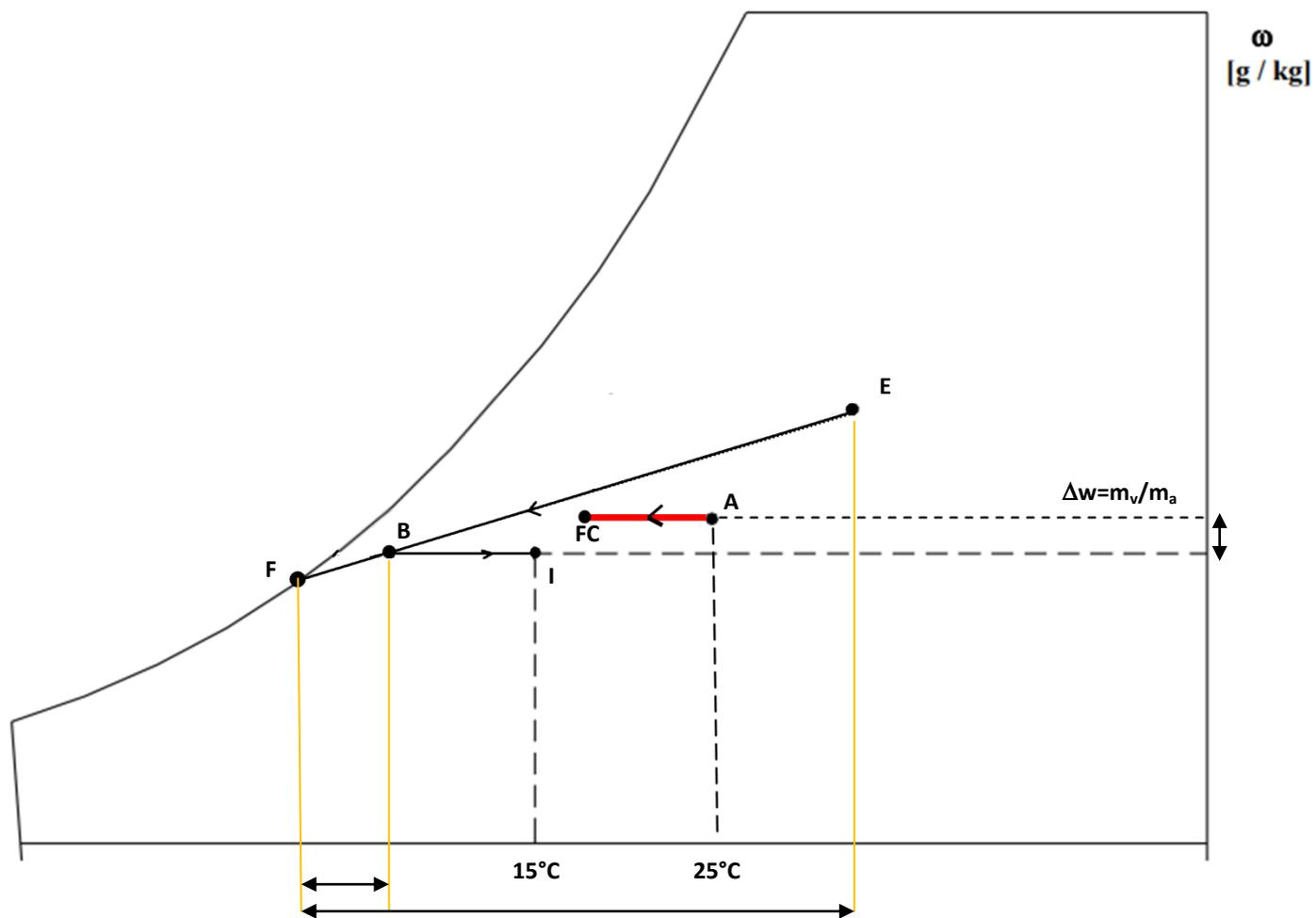
$BPS = FB / FE = \text{fattore di by-pass batteria}$
